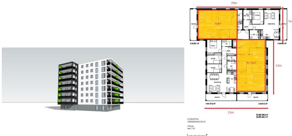
Bild 3 Ritning på byggnad som tagits fram av FO Petersson och Söner och vars mått och form använts för simuleringarna. Vid beräkningarna har åtta likadana våningsplan antagits.
